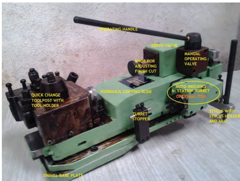
شکل ۸- بخش های مختلف دستگاه کپی تراش
