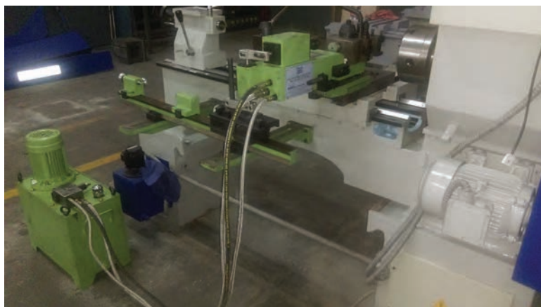
شکل ۹- دستگاه کپی تراش نصب شده روی ماشین تراش
