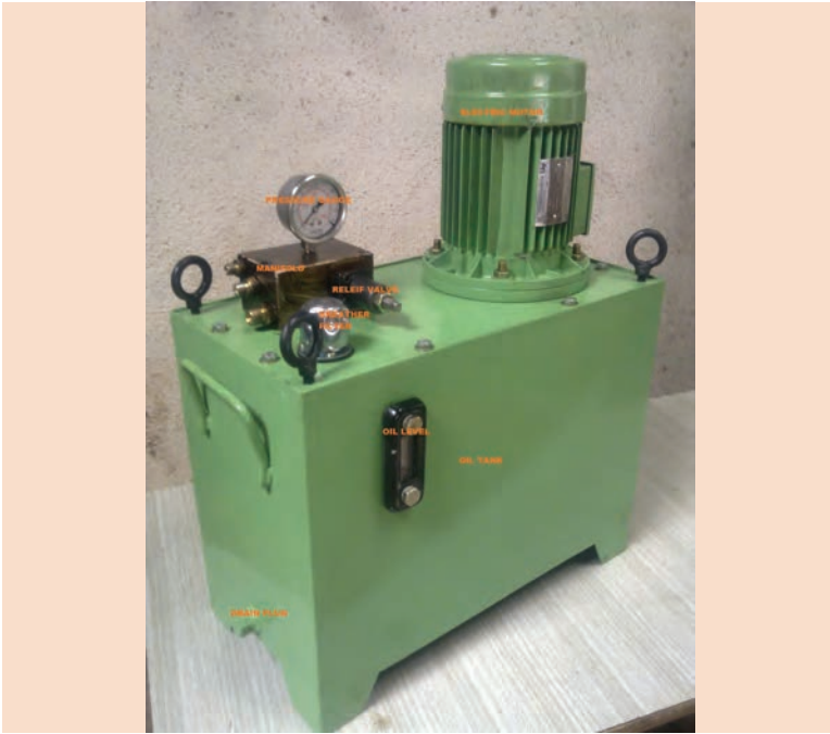
شکل ۱۰- واحد هیدرولیک دستگاه کپی تراش
